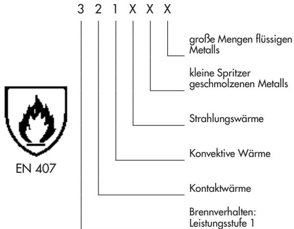
Die Kennzeichnung „X“ anstelle einer Zahl bedeutet, dass der Handschuh nicht für die Verwendung, die von dieser Prüfung abgedeckt ist, vorgesehen ist.
