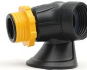
Der Y Connector dient als Adapter für den Einsatz mit zwei Filtern. Dafür wird dieser einfach mit der Motor-Einheit verbunden, wodurch zwei Filter an das System angeschlossen werden können. Dies ist vor allem dann notwendig, wenn der Smartblower gegen Gase eingesetzt wird. Zur Erhöhung des Luftvolumens und zur Verlängerung der Standzeit der Filter kann der Y-Connector auch mit zwei Partikelfiltern verwendet werden.
