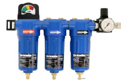
Die e-breathe Druckluft-Filterstation wurde für die Aufbereitung von technischer Druckluft entwickelt. Die in den jeweiligen Stationen enthaltenen Hochleistungsfilter scheiden Feststoffpartikel, Aerosole, Öl-Dämpfe und Gerüche der durchströmenden Druckluft ab und entfernen diese. Je nach Anwendungsgebiet wird ein 2-Stufen oder 3-Stufen Filtersystem verwendet.
